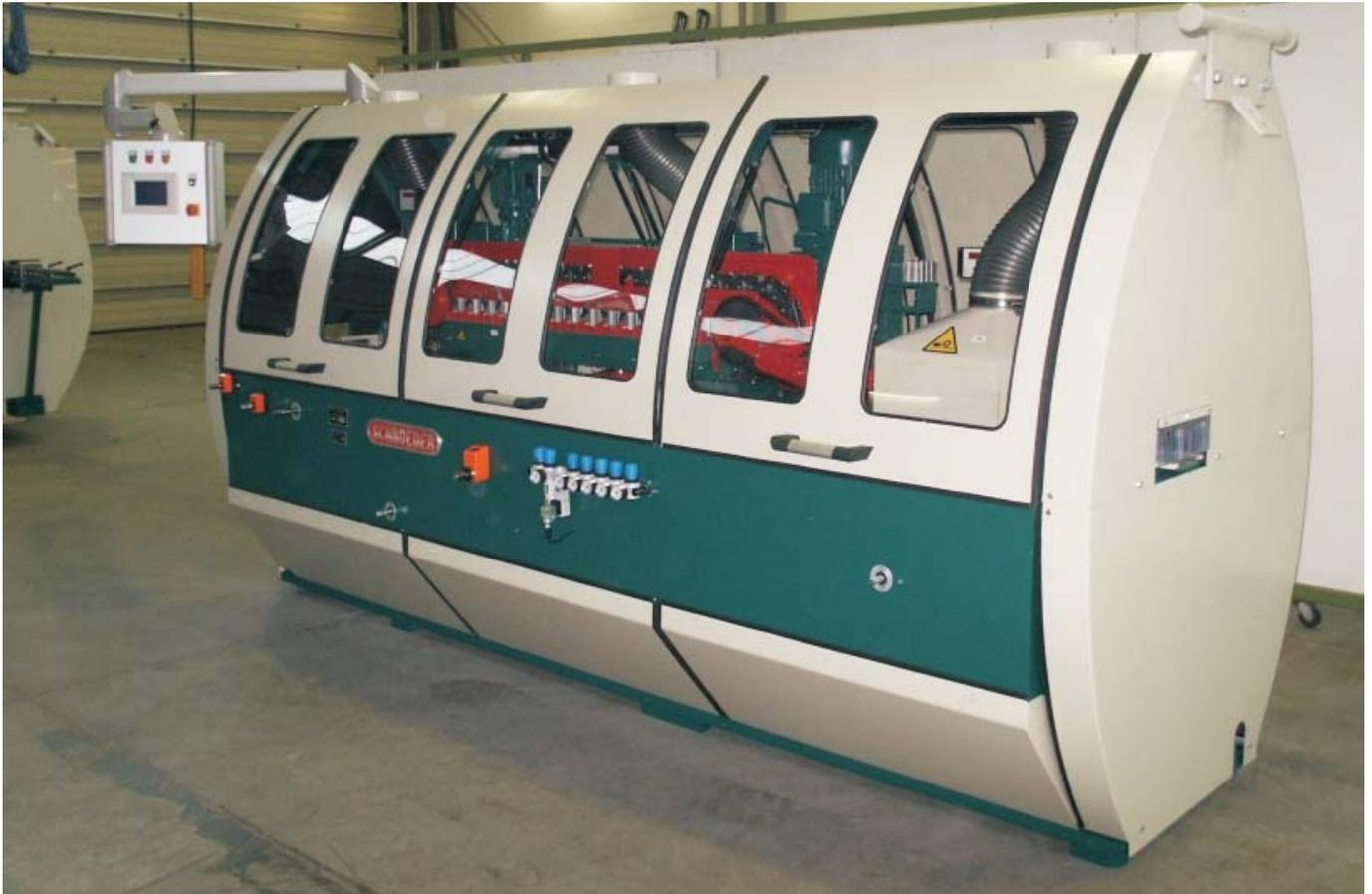
3-Seiten Vor-Hobelmaschine für höchste Leistungen (Vorschub 15 - 50 m/min.) speziell bei kurzen Holzlängen ab 200 mm.
